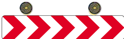
Les optiques sont placées au-dessus du signal.
