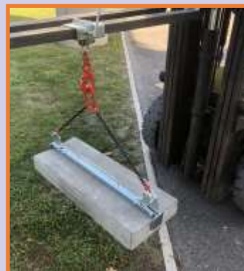
La fourche qui reçoit l'étrier est placée au milieu du tablier du chariot.
